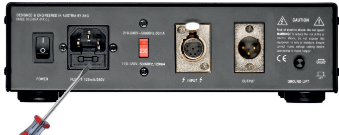
Figure 4: Ouverture du compartiment des fusibles
