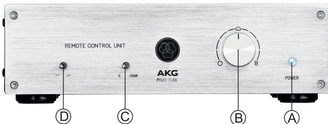
Figure 1: Commandes sur la face avant de l'unité de commande à distance
