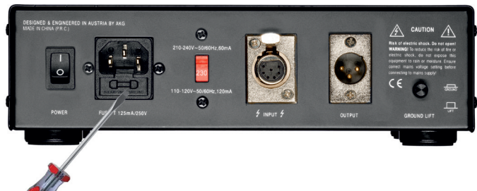
Abbildung 4: Öffnen des Sicherungsfachs
